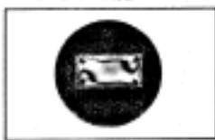
2) 直交する偏光板の間に空みのあるガラスを入れた場合
