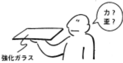
図6a 「歪み」が入っている強化ガラス 外見上は力も弾性歪みもない
